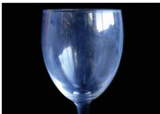
Degradación de una pieza de cristalería. Arañazos y opacidad motivados por producto inadecuado y uso incorrecto del lavavajillas.
